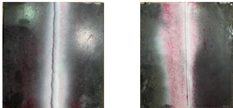
Gambar 5. Hasil Uji NDT Dye Penetrant Pengelasan menggunakan parameter kuat arus sebesar 70 ampere dengan kecepatan pengelasan 1,8 mm/s.
