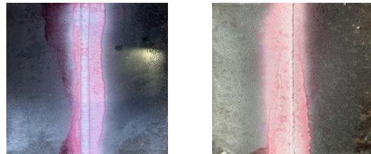
Gambar 7. Hasil Uji NDT Dye Penetrant Pengelasan menggunakan parameter kuat arus sebesar 75 ampere dengan kecepatan pengelasan 1,8 mm/s.
