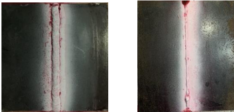
Gambar 3. Hasil Uji NDT Dye Penetrant Pengelasan menggunakan parameter kuat arus sebesar 65 ampere dengan kecepatan pengelasan 1,8 mm/s.
