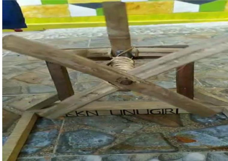
Gambar 4. Mesin Tail Pelepah Pisang
