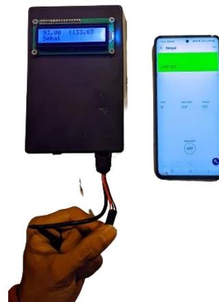
Pada tahap pengujian alat ini bertujuan agar dapat mengetahui apakah sistem dapat mendeteksi detak jantung dan suhu tubuh yang telah di konfigurasi ke aplikasi blynk melalui smartphone. Hasil pengujian akan di tampilkan pada table berikut
