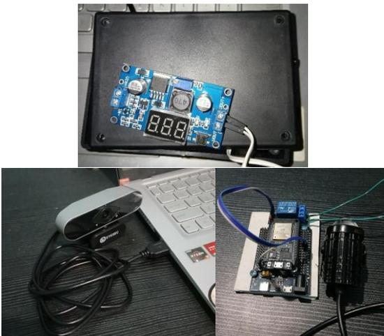
Gambar 9. Rangkaian Fisik Alat dan ESP32 Setelah Dirakit
