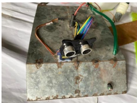
Gambar 3. Peletakan sensor ultrasonik
