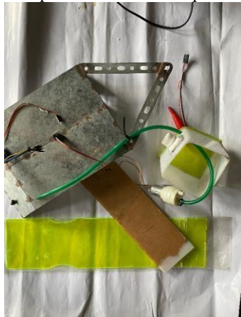
Gambar 2. Pembuatan tampungan senjata air battlebots
