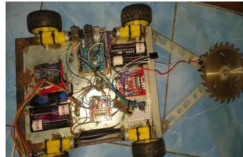
Gambar 5. Peletakan komponen dan modul sensor yang didalam robot
