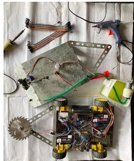
Gambar 6. Perakitan robot battlebots
